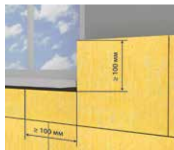
Схема правильной установки теплоизоляции вокруг проемов
